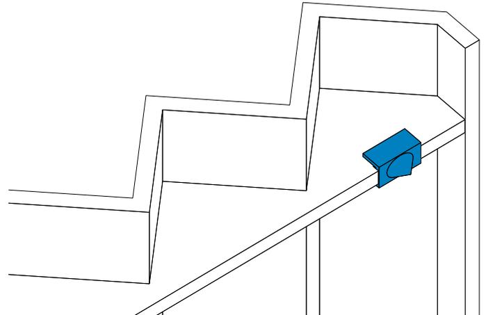
3. Positionnez maintenant le panneau à l'endroit souhaité sur le mur et appuyez fermement contre le mur – uniquement aux endroits des clips de transfert pointus. Les clips laisseront une petite "marque" sur le mur, indiquant l'emplacement requis des clips de fixation.
