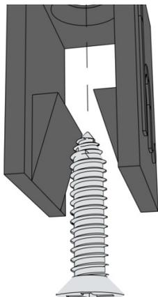
2. Une fois correctement mesuré, insérez la vis dans le mur/au plafond par le trou du support fourni en le fixant solidement.
