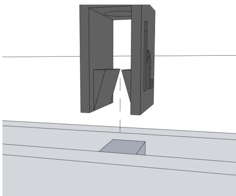
4. Faites glisser la colonne dans l'encoche du support pour la sécuriser en place.
