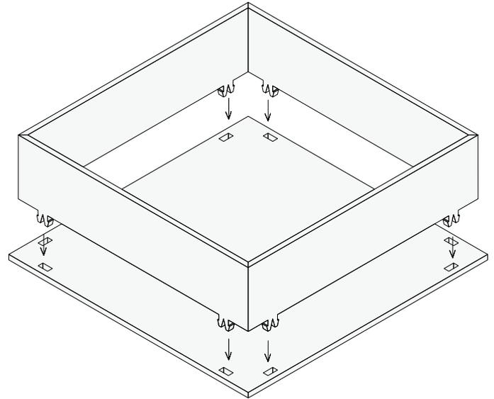
6. Assurez-vous que les languettes du panneau latéral dépassent à travers le panneau arrière et sont en position ouverte et « verrouillée » comme indiqué dans le détail ci-dessous
