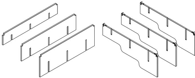
2. Commencez à insérer les parties supérieures de la cloison dans les parties inférieures en glissant les fentes découpées les unes dans les autres. Poussez fermement pour assurer une connexion sécurisée.
