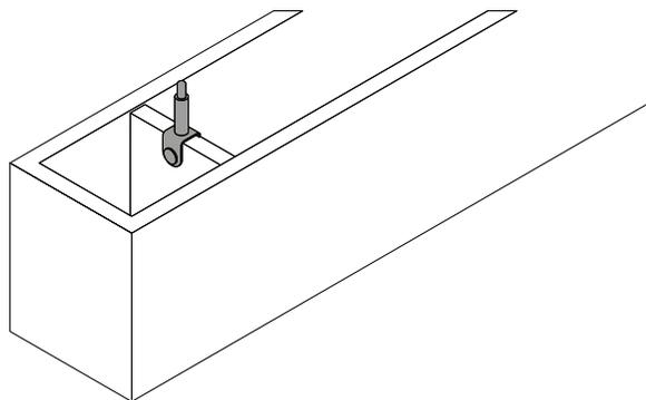
5. Insérez l'unité LED dans la partie inférieure de la poutre. Tout en soutenant le poids de l'unité LED, fixez les points de suspension de l'unité lumineuse au plafond à l'aide du matériel de plafond.
