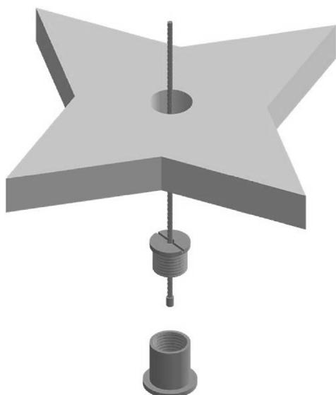
2. Maintenant, avec le Kite orienté exactement comme montré, insérez le matériel par le dessous en tirant le câble verticalement.
