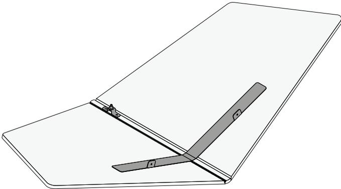
**2.** Fixez le Crochet à chape à la languette en métal comme indiqué ci-dessous, puis insérez le câble en métal dans la partie Grip-Lock du crochet.
