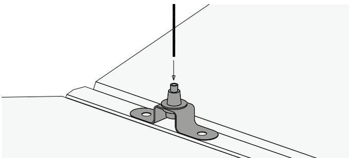
**4.** Assurez-vous que le câble passe complètement à travers l'ancre en U jusqu'à ce qu'il dépasse par le dessous du matériel.
