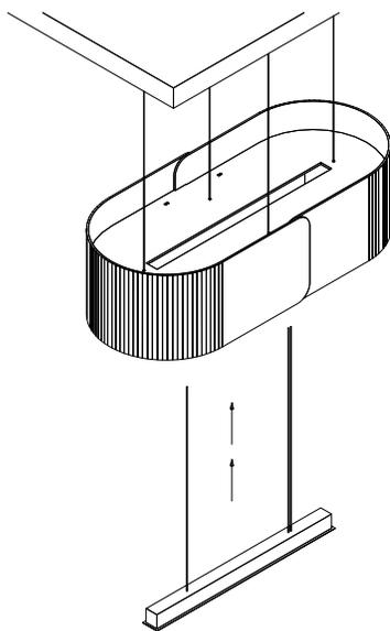
8. Tout en soutenant le poids de l'unité LED, fixez les points de suspension de l'unité lumineuse au plafond à l'aide du matériel de plafond.
