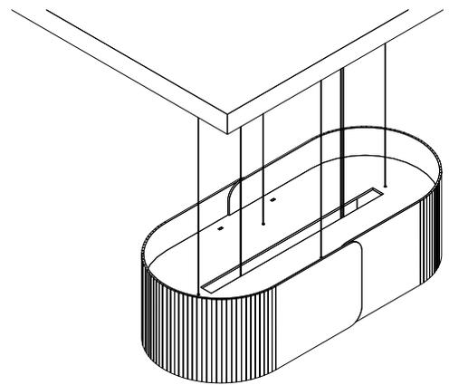
9. Maintenant, faites connecter l'éclairagiste certifié l'unité LED à la source d'alimentation, selon les codes et normes électriques requis pour votre région. Une fois la connexion électrique terminée, votre lumière Cocoon est prête à être utilisée.
