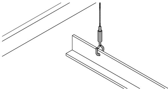
**4.** Lorsque tous les Crochets à chape sont installés, votre Cloud est maintenant complet et prêt à être suspendu au plafond.
