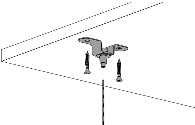
2. Insérez environ 1" du câble métallique dans l'Ancrage en U comme indiqué ci-dessous. Votre quincaillerie de plafond est maintenant installée et prête à être utilisée.
