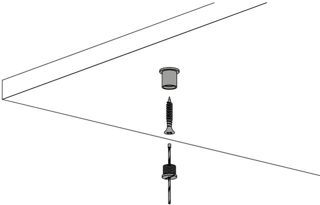
2. Vissez maintenant la partie boulon dans l'écrou fixé au plafond. Votre quincaillerie de plafond est maintenant installée et prête à être utilisée.
