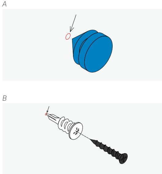
6. Fixez votre dispositif de fixation au mur, en laissant environ 6 mm (1/4") dépasser du mur.
