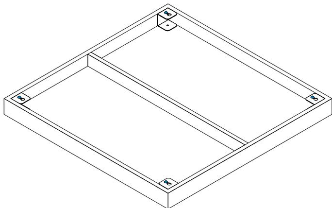
4. Maintenant, en tenant le panneau à la verticale à l'emplacement d'installation souhaité, poussez fermement le panneau contre le mur, en veillant à ne pousser qu'aux emplacements des supports de montage. Cela fera en sorte que les bouchons EZmark laissent de petites marques sur le mur à chaque emplacement de support.
