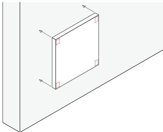
5. En utilisant les petites marques des EZmark sur le mur comme guide (A), fixez votre dispositif de fixation au mur (B).
