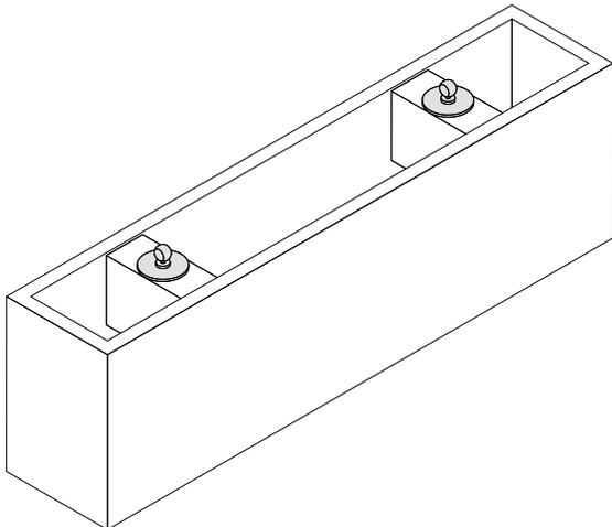
2. Mesurez la dimension centre-à-centre entre les deux clips mâles. Une fois que tous les supports sont fixés, alignez-les avec le clip déjà attaché à la colonne.
