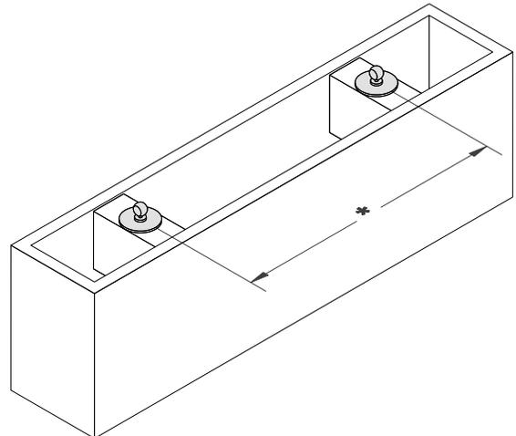
3. Montez la partie femelle des clips au plafond en utilisant des vis adaptées à votre matériau de plafond. Assurez-vous que l'emplacement centre-à-centre des clips femelles correspond aux dimensions du matériel de la Poutre.
