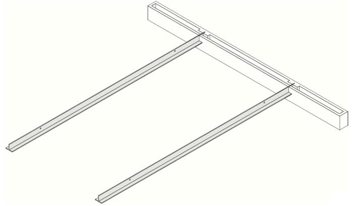
3. Faites glisser les Poutres intermédiaires (dans l'ordre numérique si indiqué sur les Poutres), en espaçant les Poutres à l'aide de l'outil de calibrage fourni.
