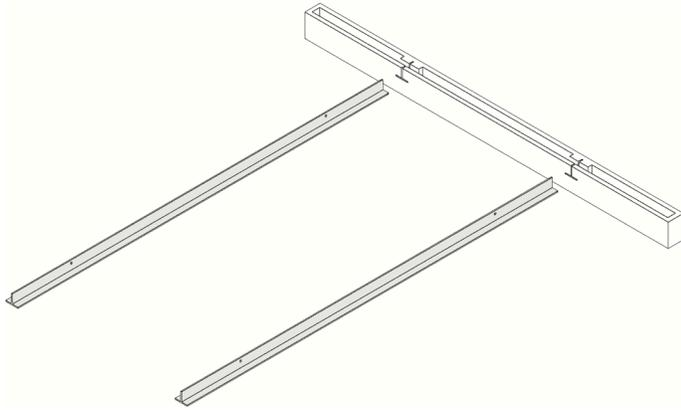
2. Insérez le T-track en aluminium dans la Poutre d'extrémité comme indiqué ci-dessous :
